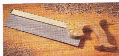
ارّه مویی: برای برش‌های ظرفی چوب، استخوان، خرک، سیم‌گیر، لوازم تزیینی و به طور کلی ظرفی‌کاری استفاده می‌گردد.
